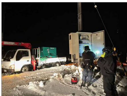
28 図4-2 トラックに積載した可搬式発電設備巡回の様子（北海道紋別市） 29
