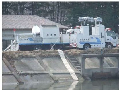
移動ポンプ車による排水
