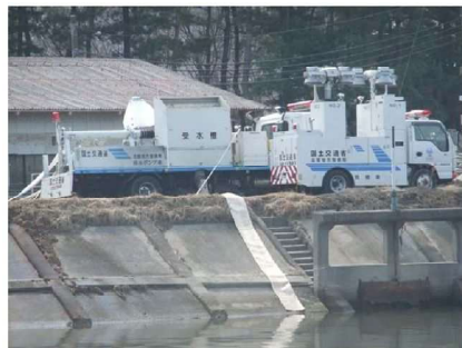
移動ポンプ車による排水
