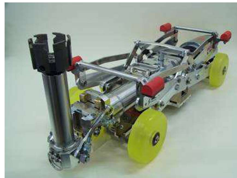
更生工法で使用される削孔機の例
