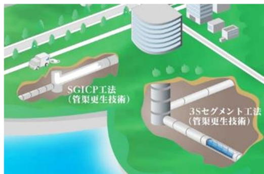
管きよ更生工法
