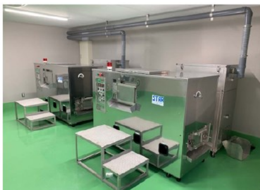
図 II-5 下水汚泥コンポスト化試験装置
