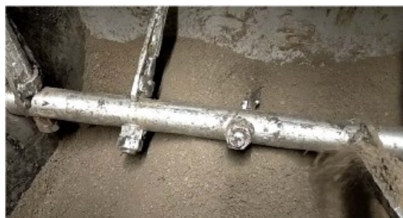
図 II-5 下水汚泥コンポスト化試験装置
