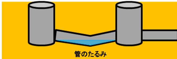
管のたるみで不具合があるものの流下機能あり
