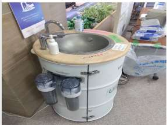
水循環型手洗いスタンド (志賀町)
