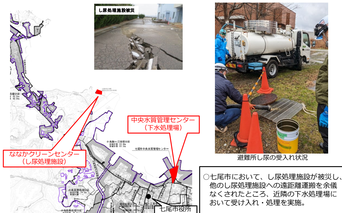
図5-11 し尿処理との連携による応急復旧（七尾市の事例）
