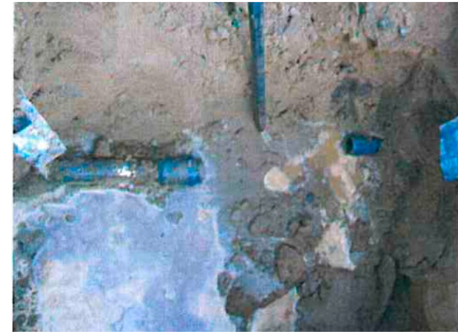
HIVP継手部抜け(石川県羽咋市)
