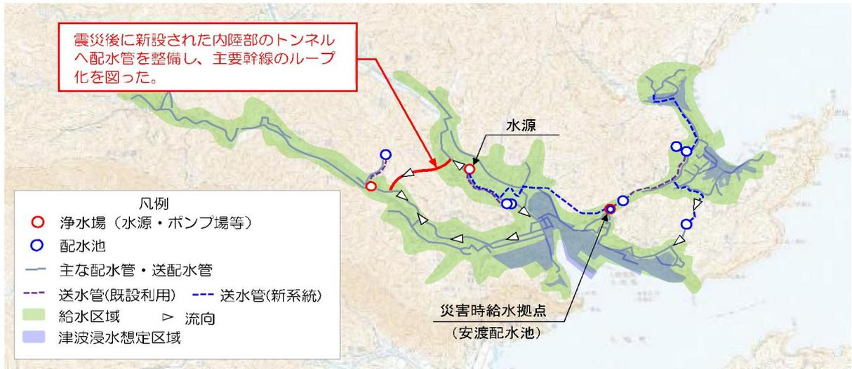
図 4 - 3 災害に強い管網整備の例 (岩手県大槌町)
