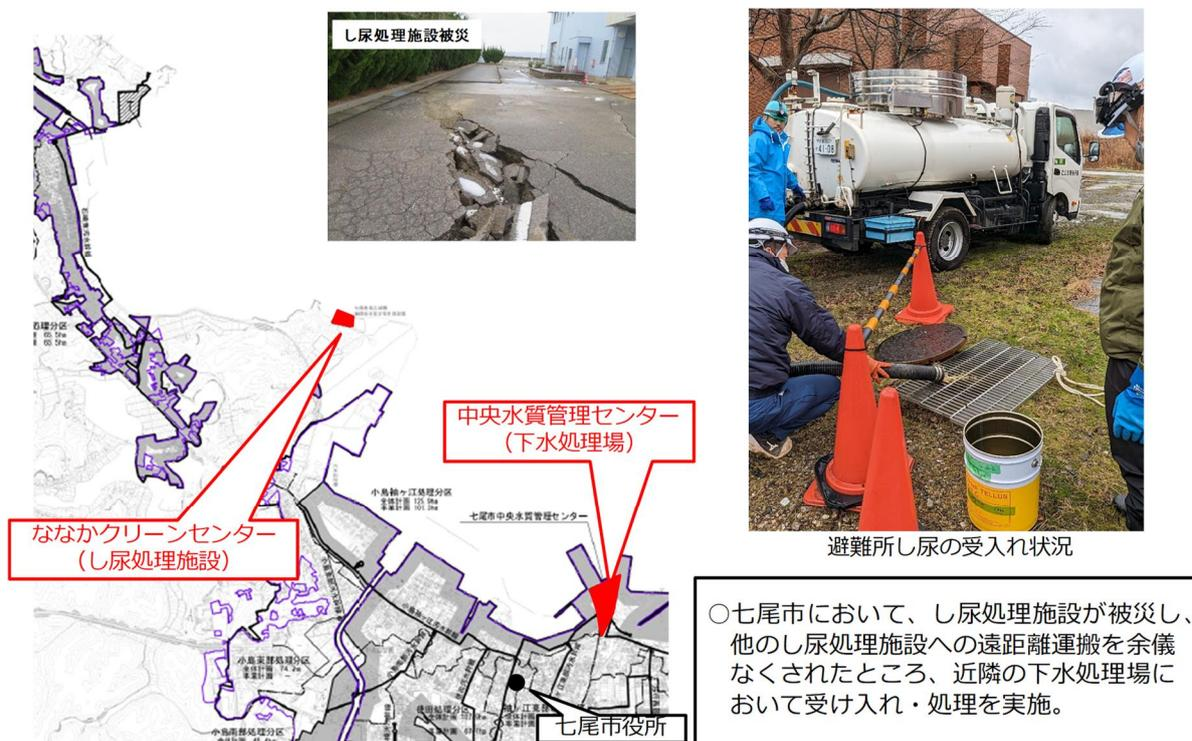
図5-1-1 し尿処理との連携による応急復旧（七尾市の事例）
