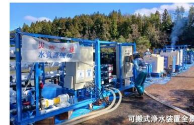
珠洲市に設置された水資源機構の可搬式浄水設備
