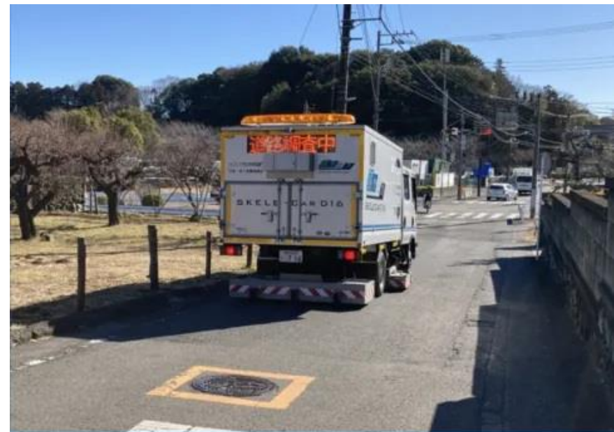
路面下空洞調査の様子 (空洞探査車による調査)
