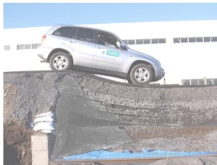
高強度のジオグリッドと拘束部材を用いた複合剛性層を路床に構築する工法です。地震による舗装の崩壊の防止や、アスファルト舗装路面の亀裂や段差の発生を抑制します。地震直後でも緊急車両の通行が可能で、人命救助や物資運搬が急務な初動を迅速に行えます。
