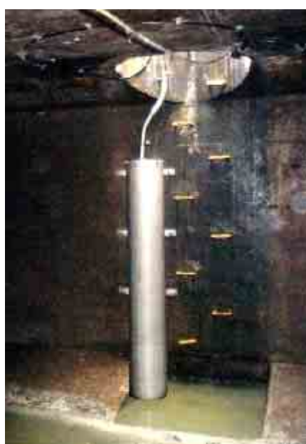
図 3-7 光ファイバーセンサによる水位測定例
