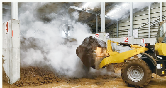
汚泥コンポストの製造状況（高島浄化センター）
