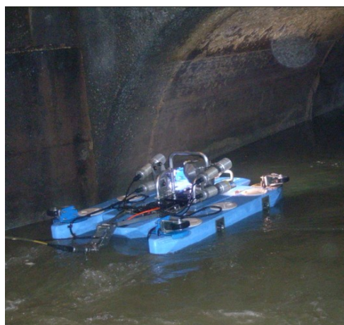
船体式テレビカメラ調査の様子と確認した異状箇所（管路内面の腐食あり）
