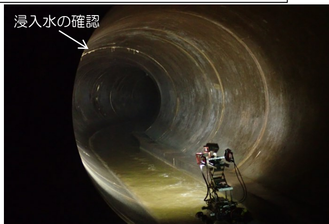
自走式テレビカメラ調査の様子と確認した異状箇所（浸入水あり）
