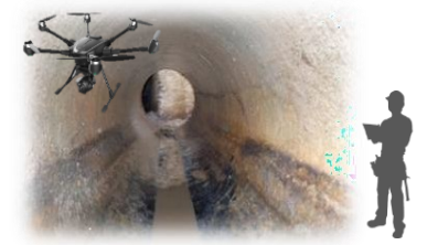
管路等劣化状況点検用ドローン
