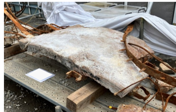
写真③ 回収RCセグメント3 (事故後撮影)
