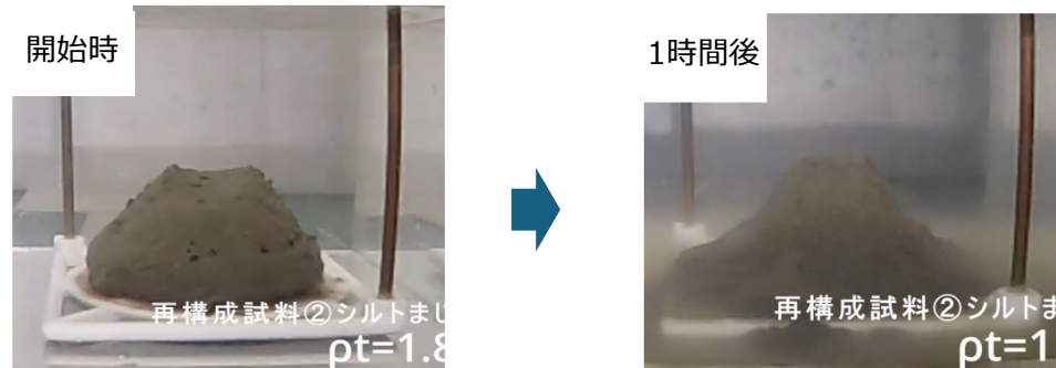
図5.9 浸水試験結果
