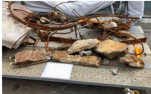
写真② 回収RCセグメント2 (事故後撮影)
