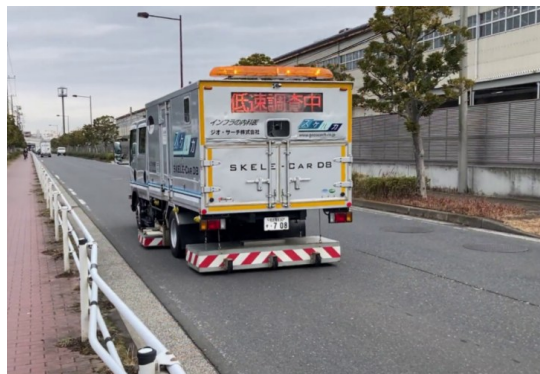
路面からの空洞調査 （車両型）
