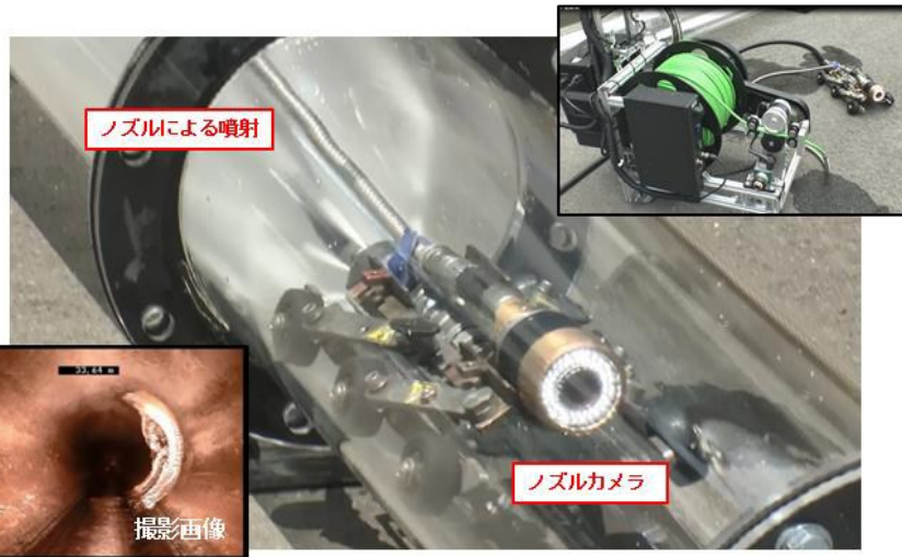
ノズルカメラと撮影した管内の画像
