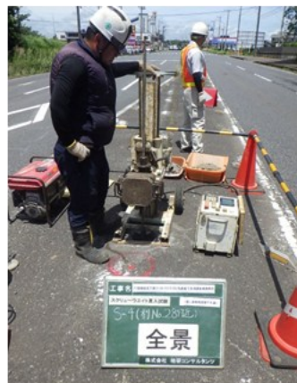
貫入試験による空洞調査
