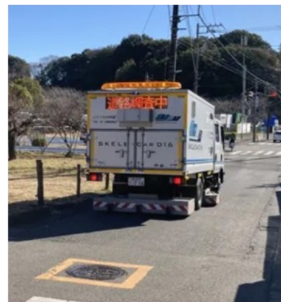
空洞探査車による空洞調査
