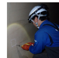
テストハンマーによる打音調査
