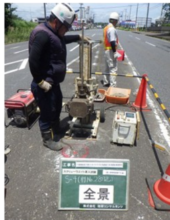
貫入試験による空洞調査
