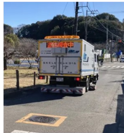
空洞探査車による空洞調査
