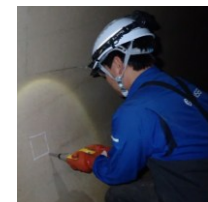
テストハンマーによる打音調査
