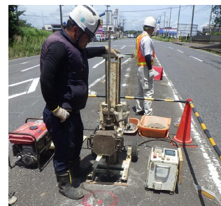
貫入試験による空洞調査
