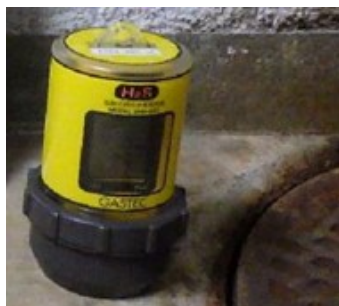
拡散式の硫化水素ガス測定器
