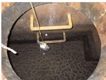
拡散式の硫化水素ガス測定器
