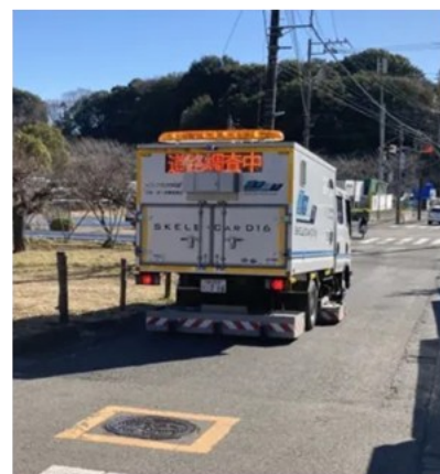
空洞探査車による空洞調査
