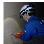
テストハンマーによる打音調査
