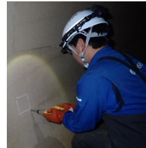
テストハンマーによる打音調査
