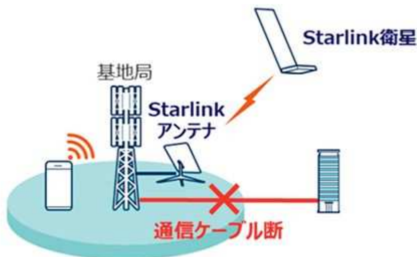
図 2-9 Starlink のバックホール回線活用による基地局応急復旧のイメージ
