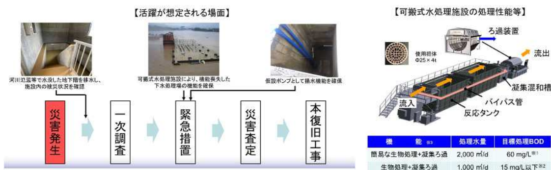
図 4-8 活用が想定される場面と可搬式水処理施設の概要
