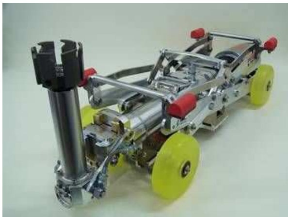
図 4-7 更生工法で使用される削孔機の例
