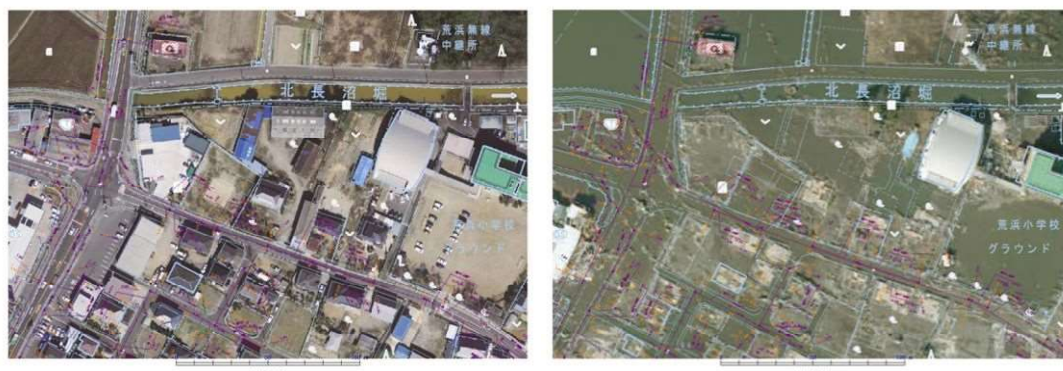
電子化された下水道台帳を被災後の航空写真に重ねて利用。調査の効率化（仙台市）
