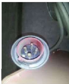
発電機用のケーブルジャック (ポンプ能力により形状が異なるため、事前に確認すること)
