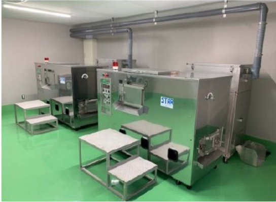
図 II-6 下水汚泥コンポスト化試験装置
