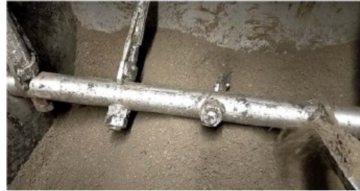
図 II-6 下水汚泥コンポスト化試験装置
