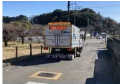
（空洞探査車による調査）
