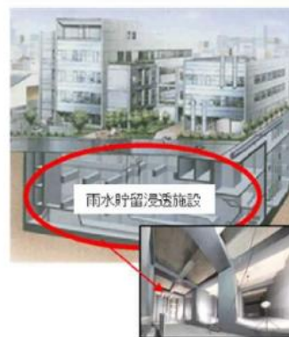
雨水貯留浸透施設の整備イメージ
