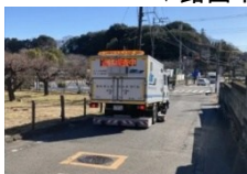
(空洞探査車による調査)
