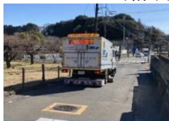
（空洞探査車による調査）
