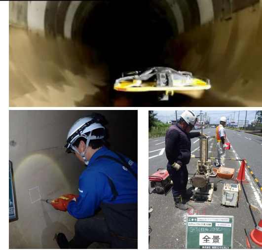
(左上) ドローンによる目視調査 (左下) リバウンドハンマーによる打音調査等 (右下) 貫入試験による空洞調査
