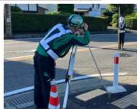
道路の変位計測（1回/2時間、24時間体制）
