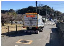
(空洞探査車による調査)
