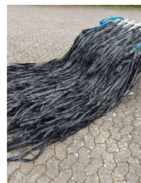
NitriStar module (biofilm filaments)
