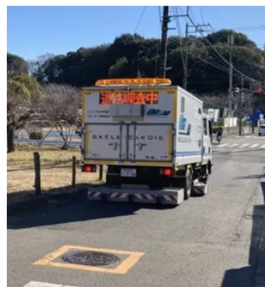
空洞探査車による空洞調査
