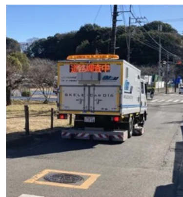
空洞探査車による空洞調査
