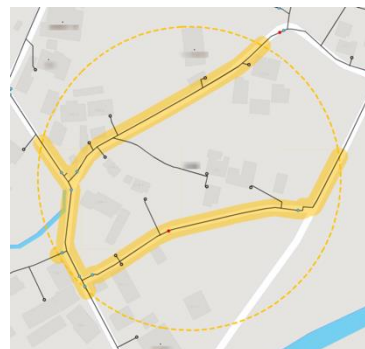
漏水可能性エリアのアプリ表示例
