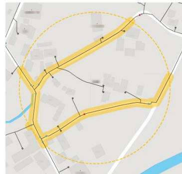
漏水可能性エリアのアプリ表示例
