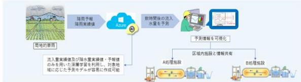
■ AIを用いて降雨量と処理施設への流入水量等の機械学習を行い、雨天時の流入水量を高精度で予測して施設の運転を支援します。
