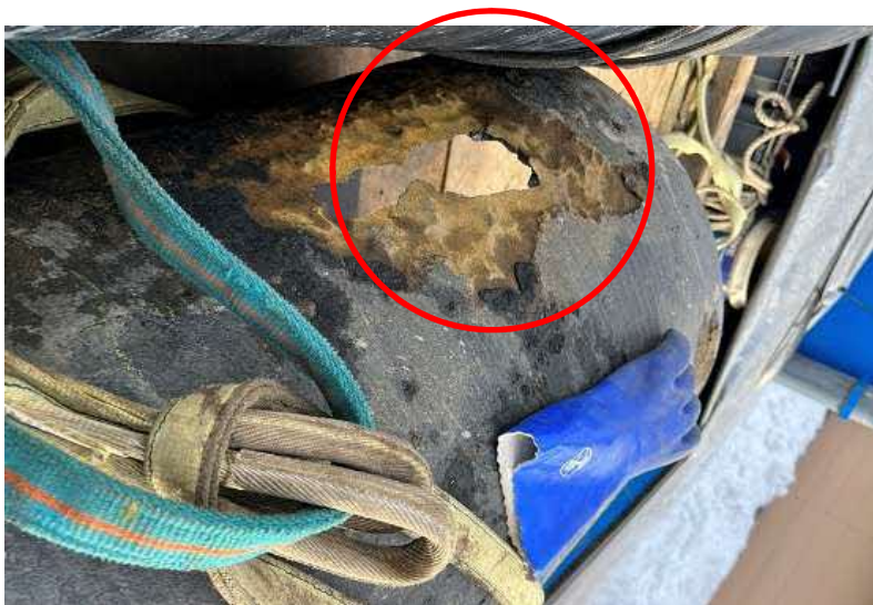
管破損状況 （掘り上げ後）
