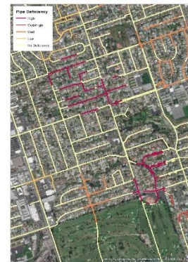
水道管路・リスク評価のアプリ表示例（色分けでリスク表示）
