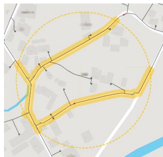
漏水可能性エリアのアプリ表示例
