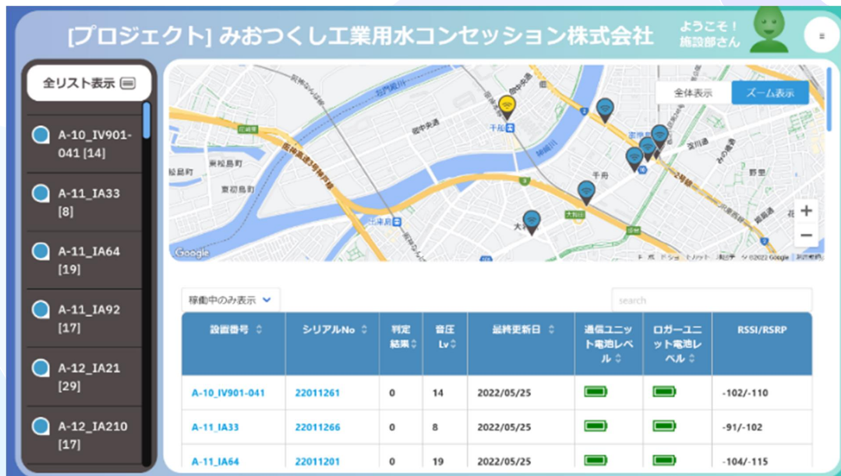
漏水センサのクラウド監視画面
